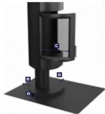
Le dimensionnement de la plaque de sol doit délimiter des distances de sécurité minimum (Sur les côtés "A", à l'arrière de l'appareil "B", et sur la face avant "C", dite zone de chargement), en fonction de la taille de l'appareil de chauffage au bois. Ces distances de sécurité sont mentionnées dans la notice de pose du fabricant du poêle.
